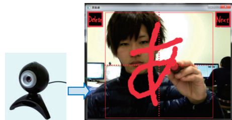
図2 画像処理を用いた文字認識
