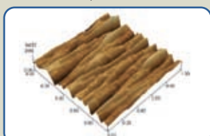
光加工によるナノ構造 Nanostructure by Laser Ablation
