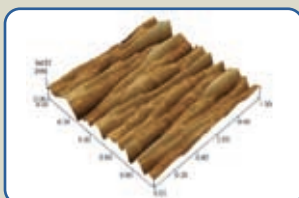
光加工によるナノ構造 Nanostructure by Laser Ablation
