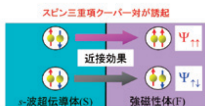
図.1 超伝導/強磁性接合において、近接効果によって出現するスピン三重項クーパー対の概念図
