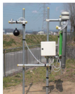
図1 定点観測型WBGT自動測定システム
