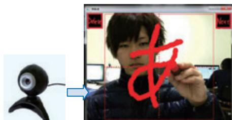
図2 画像処理を用いた文字認識
