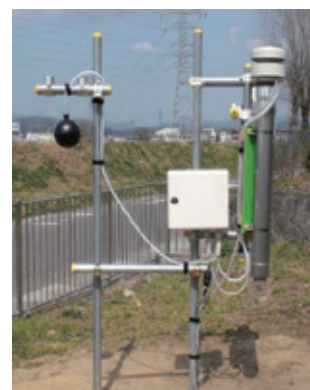
図1 定点観測型WBGT自動測定システム
