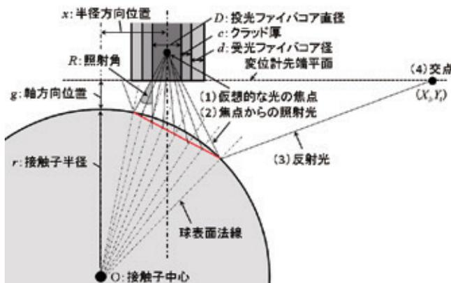
図1. 反射光線の幾何光学的な導出
