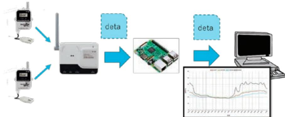
図1 マイコン等を用いたデータ計測
