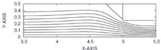
特異流れのひとつとして、急縮小流れで発生するDivergence Flowがあります。この流れはプラスチックの射出成型などで実際に観察することができます。右上の図は、Divergence Flowを数値シミュレートした結果です。
