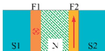
図.2 超伝導体(S), 強磁性体(F)そして常磁性体(N)から構成される多重接合(左の図)で、スピン三重項クーパー対のスpinによってNに誘起される磁化のS間の位相差の依存性(右の図)
