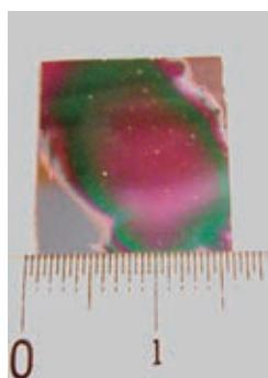
Fig. 1 基板温度150°Cで合成したZnO膜
