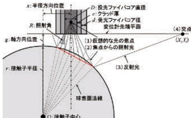
図1. 反射光線の幾何光学的な導出
