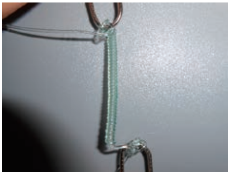
図1 自作したナイロン人工筋肉
