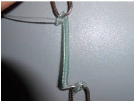
図1 自作したナイロン人工筋肉
