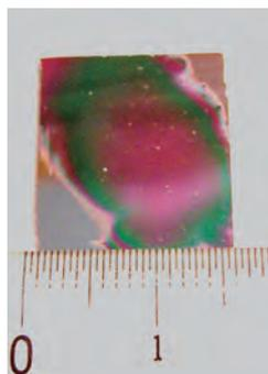
Fig.1 基板温度150°Cで合成したZnO膜
