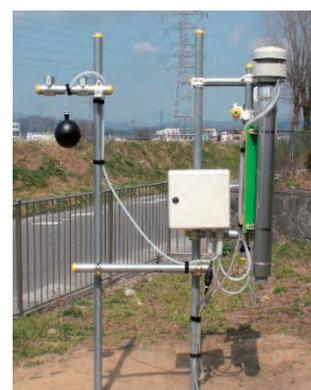
図1 定点観測型WBGT自動測定システム
