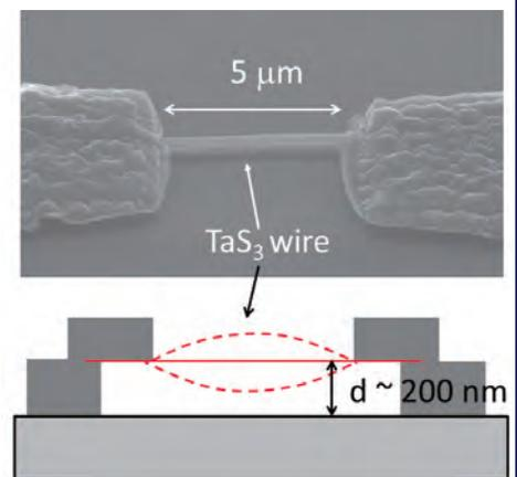
図. 作成した両端支持梁型 CDW ナノ共振子の走査電子顕微鏡像と模式図
