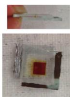
色素増感太陽電池の構造 色素増感太陽電池の外観
