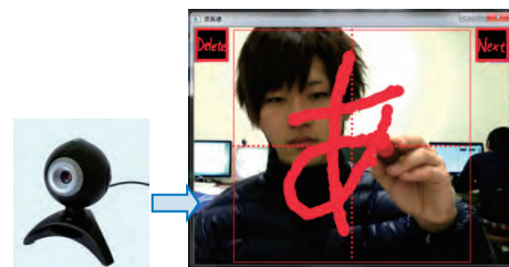
図2 画像処理を用いた文字認識
