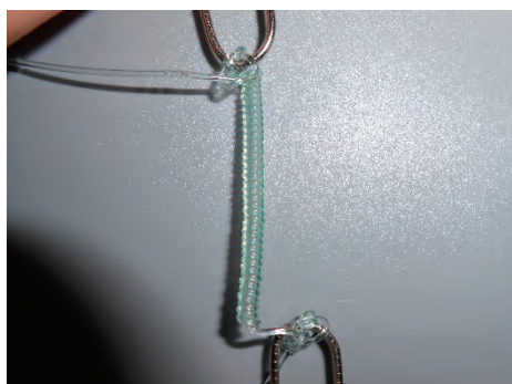
図1 自作したナイロン人工筋肉
