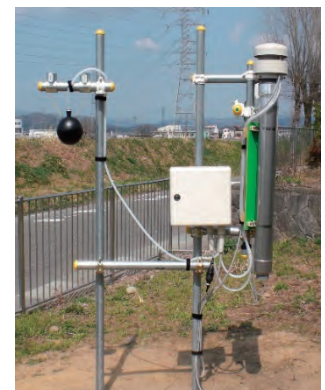
図1 定点観測型WBGT自動測定システム
