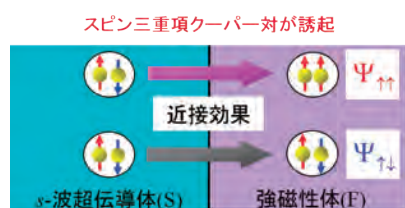
図.1 超伝導/強磁性接合において、近接効果によって出現するスピン三重項クーパ対の概念図
