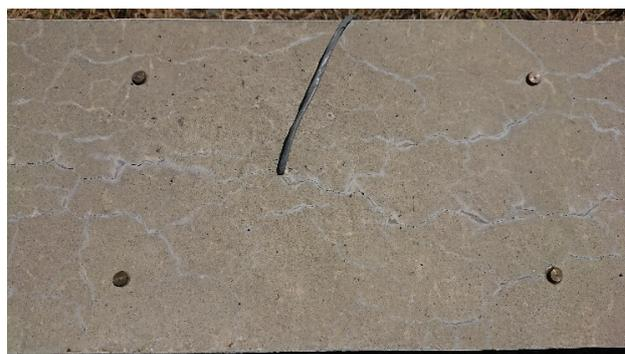
ASR による膨張ひび割れ
