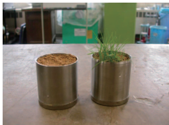
保水性試験のサンプラー(ホルダー)
