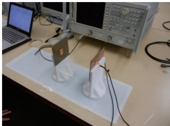
アンテナ測定実験の様子
