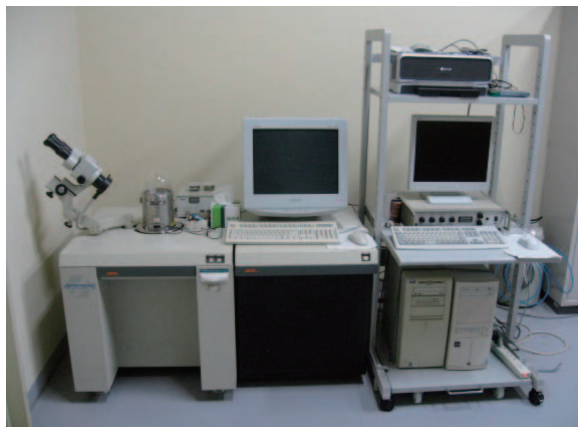
①ナノメカニカル試験用 SPM
