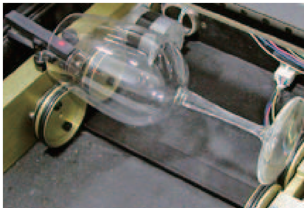
ロータリーアタッチメントによる円筒物の加工
