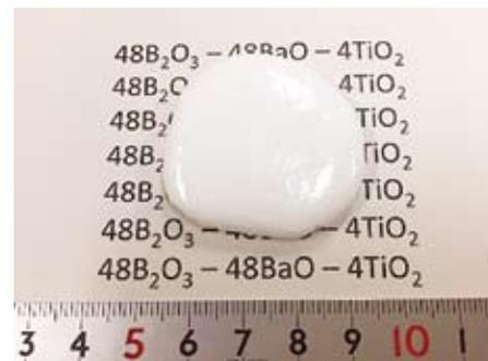
図 4  $625^\circ\text{C}$ 、30 時間熱処理した  $48\text{BaO}-48\text{B}_2\text{O}_3-4\text{TiO}_2$  結晶化ガラス。
