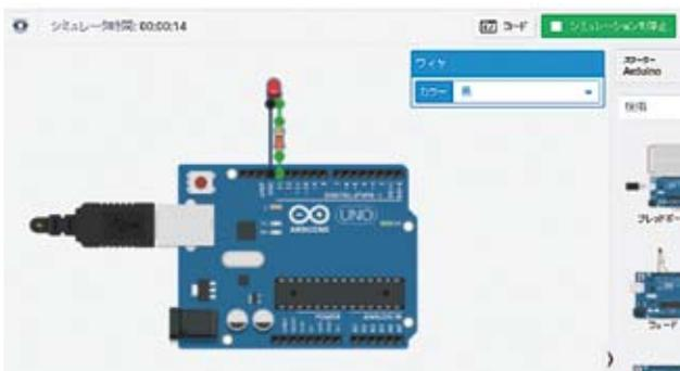
図 1 Arduino シミュレータ上での LED の点滅の様子
