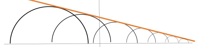
反射面に斜めに差し込むと 光路差が発生 Oに差し込んだ光とAに差し込んだ光の光路差はCA Aに差し込んだ光はに光が差し込んだ時点でOB=CAとなる点Bに到達半 径分の光路差がある点Aと点Bを結ぶと それが波面となる。
