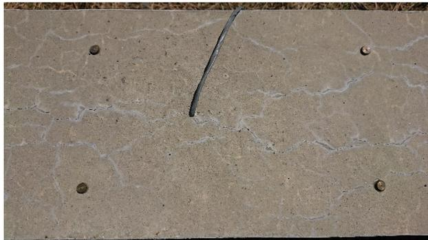
ASRによる膨張ひび割れ
