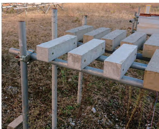
コンクリートの屋外暴露実験
