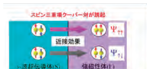
図.1 超伝導/強磁性接合において, 近接効果によって出現するスピン三重項クーパ対の概念図
