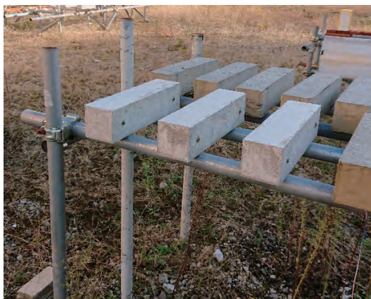
コンクリートの屋外暴露実験
