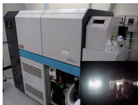
図2 高分解能 ICP-MS 装置による微量元素の分析
