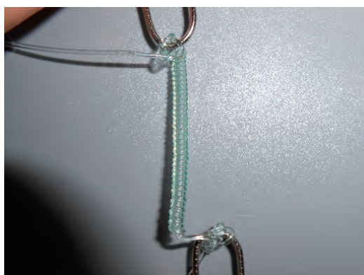
図1 自作したナイロン製人工筋肉
