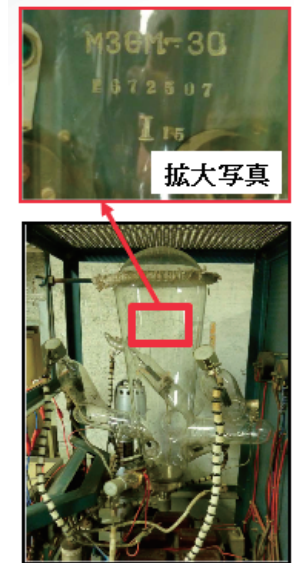
上図：鹿児島大学博物館所蔵に係る直流電源内蔵の水銀整流器に関する履歴調査から
