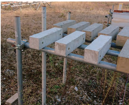
コンクリートの屋外暴露実験
