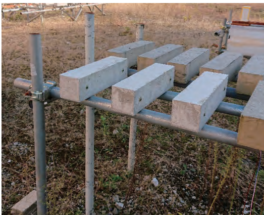
コンクリートの屋外暴露実験
