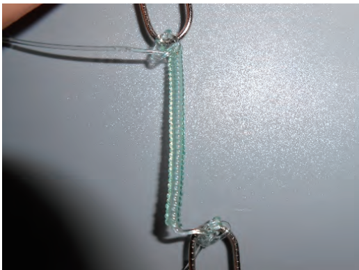
図1 自作したナイロン製人工筋肉
