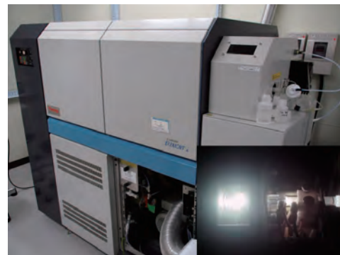
図2 高分解能 ICP-MS 装置による微量元素の分析
