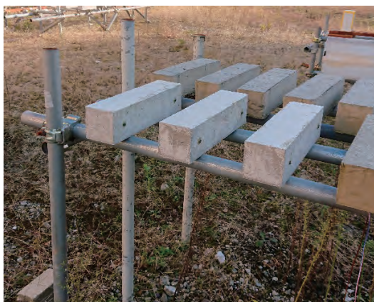
コンクリートの屋外暴露実験
