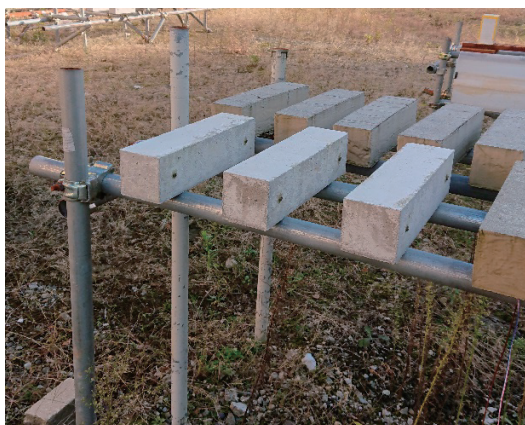
コンクリートの屋外暴露実験
