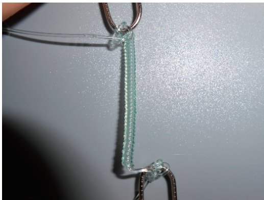
図1 自作したナイロン製人工筋肉
