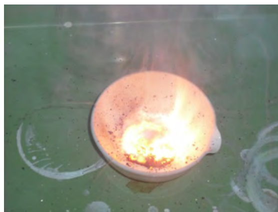
図1 過マンガン酸カリウムとグリセリンの混触燃焼の様子
