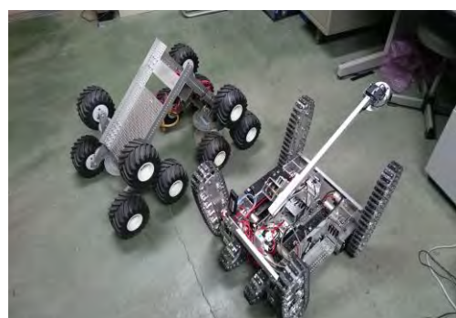
図4 クローラー型とタイヤ型
