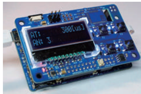
図3 簡易分光光度計モジュール
