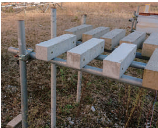
コンクリートの屋外暴露実験
