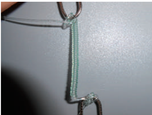
図1 自作したナイロン製人工筋肉
