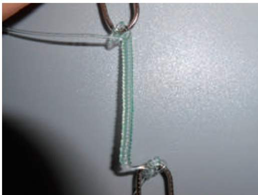
図1 自作したナイロン製人工筋肉
