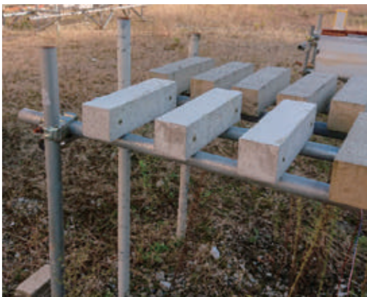
コンクリートの屋外暴露実験
