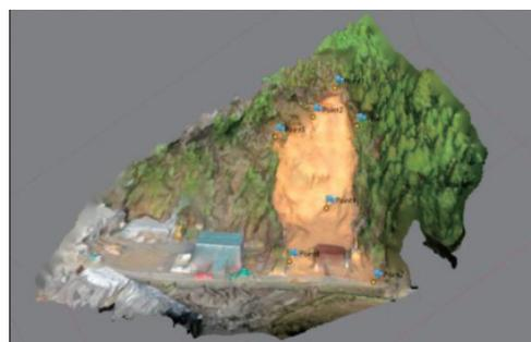
斜面崩壊箇所の 3D モデル
