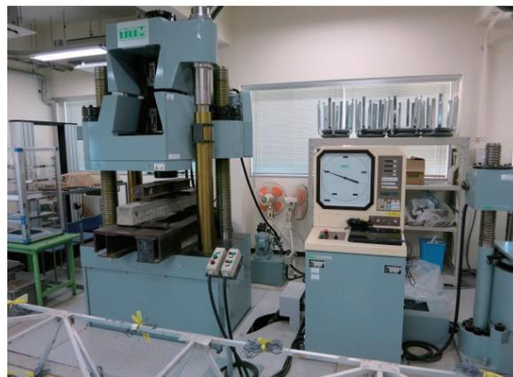
制御装置と万能試験機
