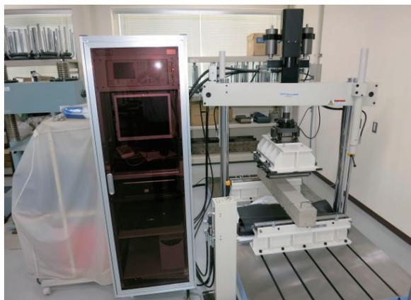
制御装置と疲労試験機
