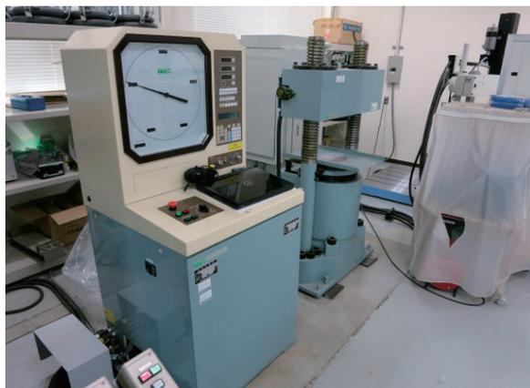
制御装置と圧縮試験機
