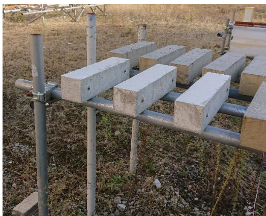
コンクリートの屋外暴露実験
