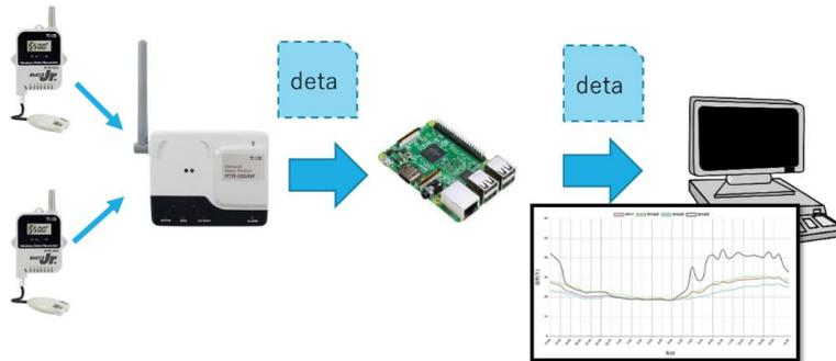
図1 マイコン等を用いたデータ計測
