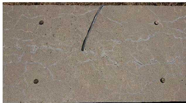
ASR による膨張ひび割れ
