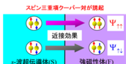
図.1 超伝導/強磁性接合において, 近接効果によって出現するスピン三重項クーパー対の概念図
