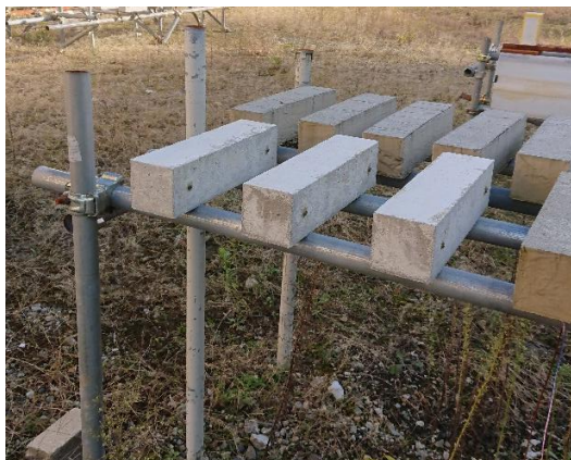
コンクリートの屋外暴露実験
