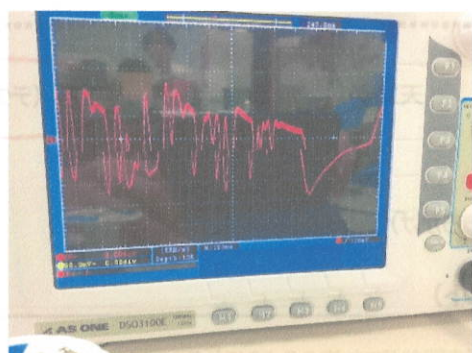
図3 オシロスコープで観測したドップラー動体検知キットの速度信号
