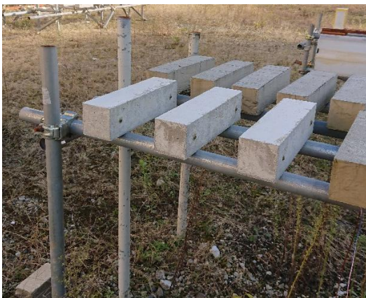
コンクリートの屋外暴露実験
